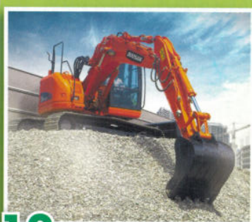
Graafmachines met korte draaicirkel Pelles à rayon arrière court
