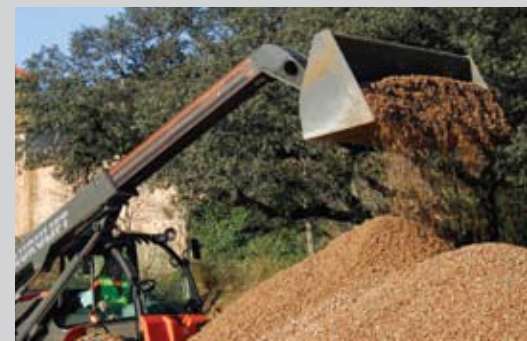
AUSA hidraulic bucket (700 l.)
