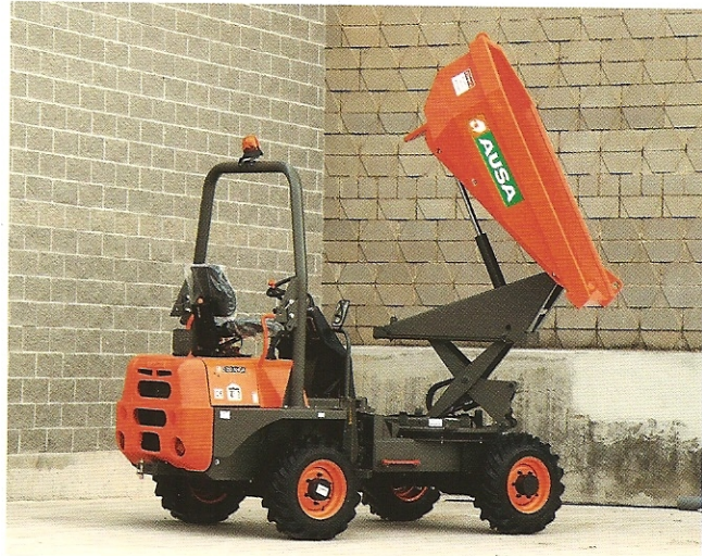
Die neuen Dumper sind dank drehbarer Hochkippmulde flexibel einsetzbar.
